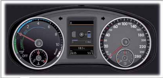
Schalttafeleinsatz mit Powermeter
