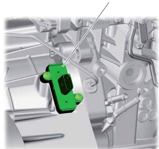
Geber 1 für Rotorposition des Fahrmotors G713
