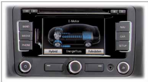
Radio- und Radio-Navigationssystem mit hybridspezifischen Anzeigen
