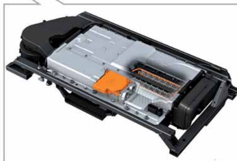
Hochvoltbatterie im Gepäckraum
