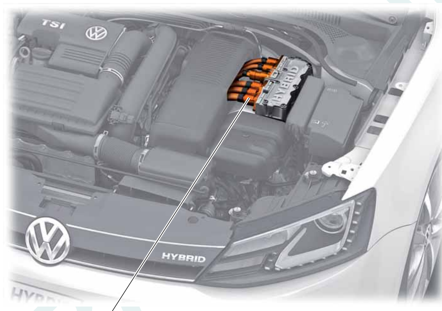
Leistungs- und Steuerelektronik für Elektroantrieb JX1
